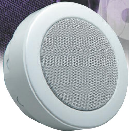
Der SENTRY 6/RTC ist ein runder, gegen Vandalismus geschützter Metall-Aufbaulautsprecher, hergestellt aus hochwertigem, mit Kunststoff überzogenem Qualitätsstahl. Er kann sowohl auf festen Decken als auch an Wänden montiert werden. Geliefert mit zwei Durchführungen, die dem Installateur die Möglichkeit des Durchschleifens bieten, was folglich die Notwendigkeit eines separaten Anschlusskastens vermeidet, sind diese Wandaufbaulautsprecher robust und ästhetisch.
