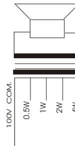
1. Die Verkabelung des Lautsprechers erfolgt entweder durch die Mitte der Montagerückwand oder durch die 2 x 20 mm Kabeleinführungen oben an der o.g. Montagerückwand (siehe Zeichnung oben).
