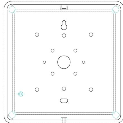
Die Montagerückwand wird auf einer glatten Fläche Mittels der vorgesehenen Befestigungsbohrungen befestigt. Nach Einführung des Kabels, den Lautsprecher anschließen und die gewünschte Leistungsanpassung vornehmen (siehe Leistungsanschlussbelegung).
